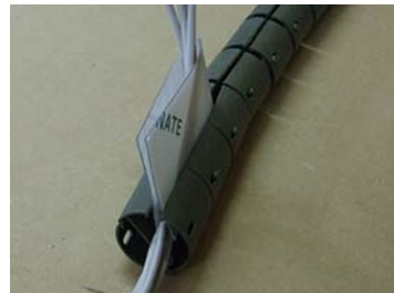
Kabels inritsen met meegeleverde tooltje. Begin altijd aan de zijde van het schakeltje met de twee slobgaten. Dit is tevens de bovenzijde van de Slurf of Chipchain. Rits de kabels van bovenzijde Slurf of Chipchain naar de onderzijde ervan.
